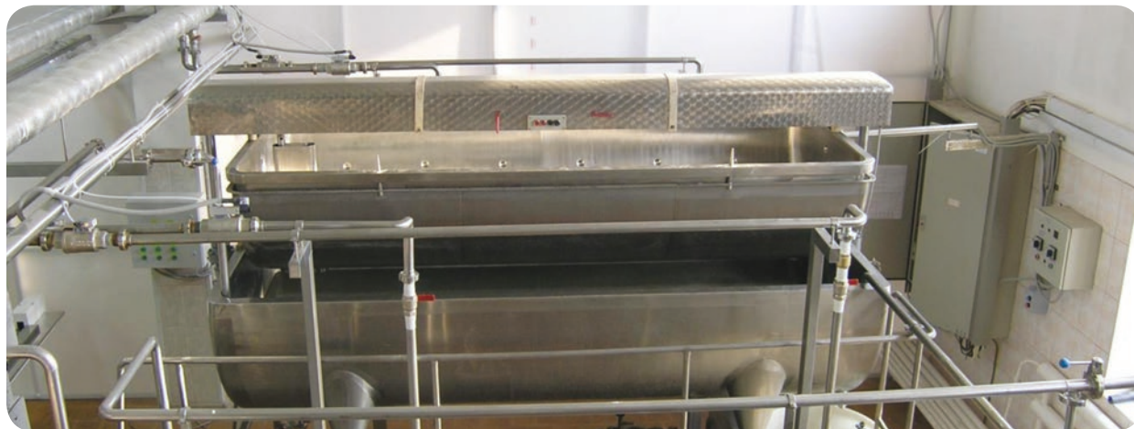
Рис. 4. Автоматизированные процессы нагревания-охлаждения в творогоизготовителе с прессующей ванной
