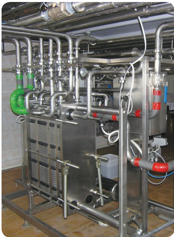
Рис. 3. Пластинчатая ПОУ на 5 т/ч с подводом теплохладоносителей
